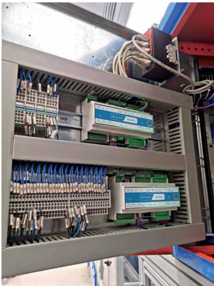
Device IIoT di Zerynth installati su macchinari industriali
